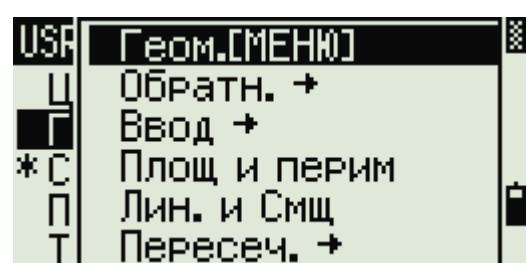
Чтобы присвоить определенную функцию из подменю, нажмите клавиши курсора или чтобы выделить имя нужной функции. Затем нажмите **[ENT]**.
