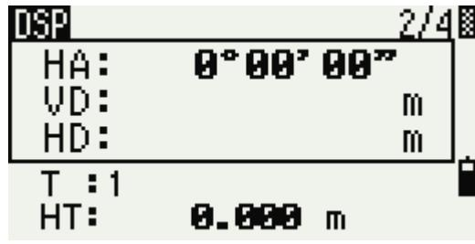
Например если текущий экран DSP2 при нажатии клавиши **DSP** появится экран 3 и индикатор экрана поменяет значение с **2/4** на **3/4**.
