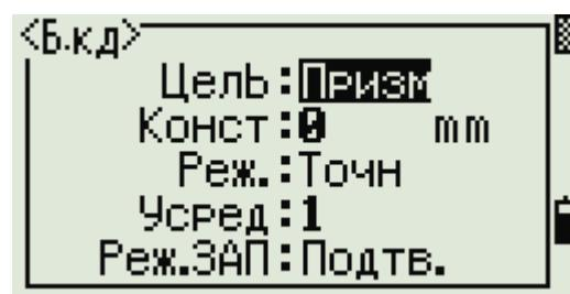
При измерениях Быстрых кодов режим записи может быть установлен только как «Подтв.» или «ВСЕ».
