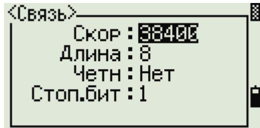
Соедините инструмент с компьютером при помощи кабеля RS-232C.
