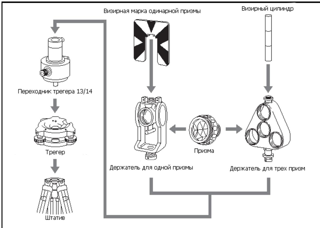
Рисунок 2.1 Сборка призменного отражателя.
