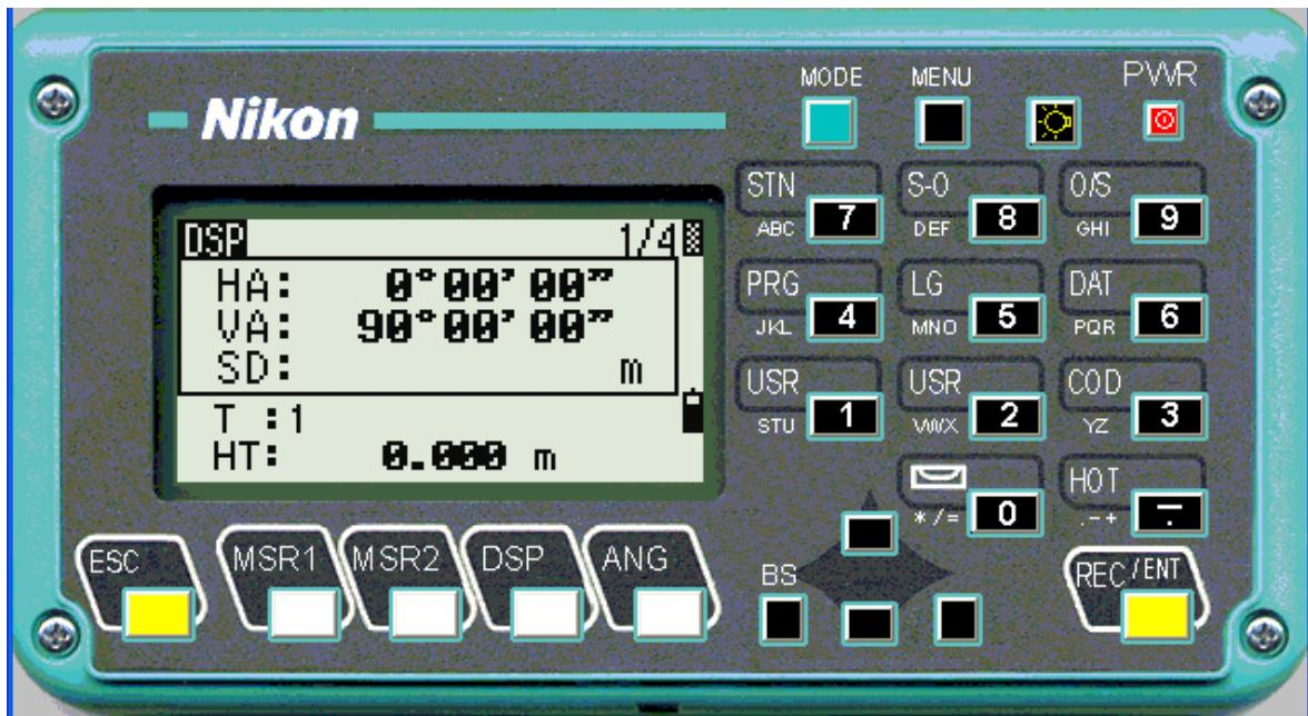
Рисунок 3.1 Клавиатура и дисплей DTM-302.
