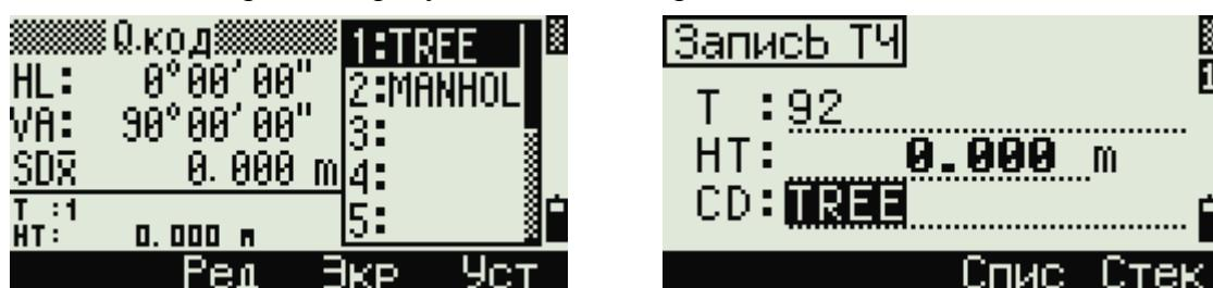
Для назначения числовым клавишам новых кодов, выберите клавишами курсора или код, который вы хотите изменить. Затем нажмите программную клавишу «Ред». Вы можете использовать программную клавишу «Экр» чтобы поменять показываемые на измерительном экране величины таким же образом, как и в случае использования клавиши на Экране основных измерений.
