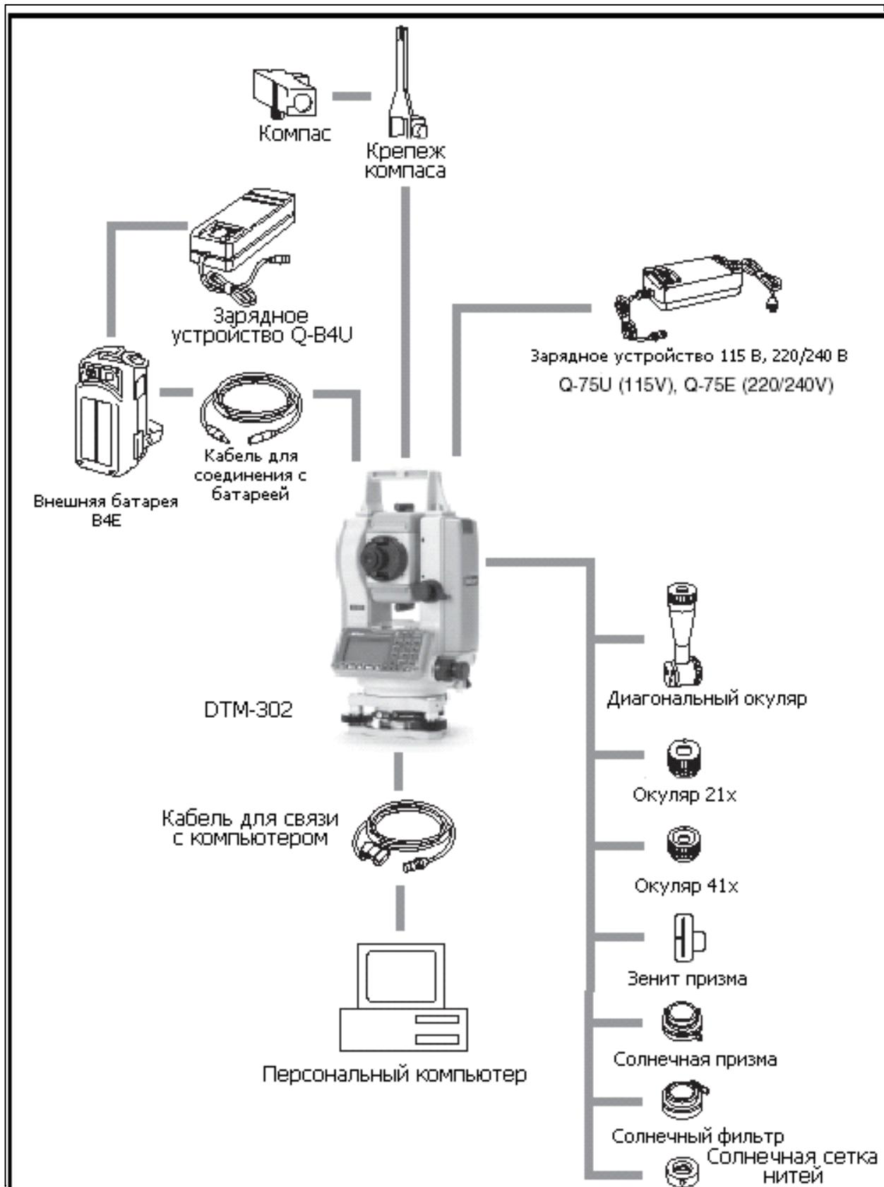
Рисунок 8.1 Измерительный комплекс
